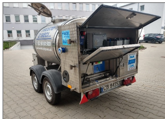
Moduł Aquasave zabudowany na istniejącej przyczepce ze zbiornikiem.
