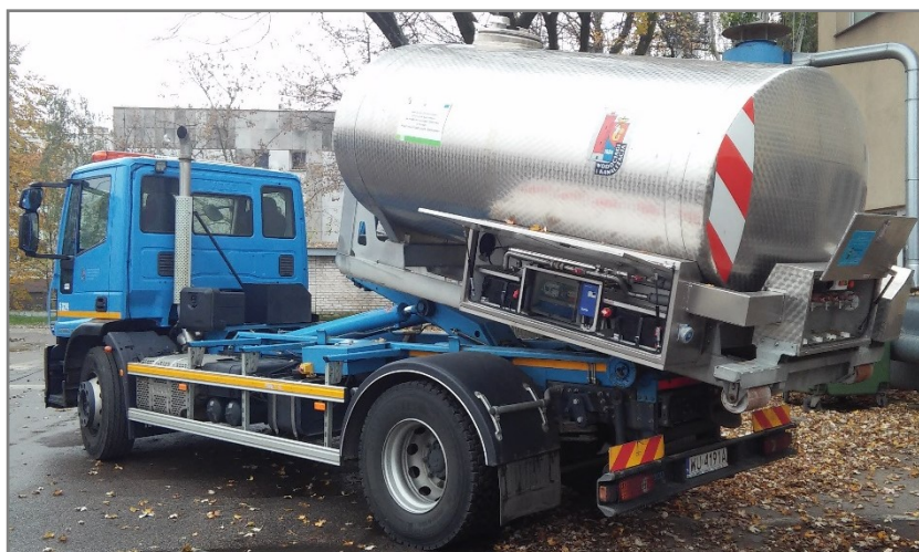
Moduł dezynfekcji został zabudowany na istniejącej cysternie pracującej w systemie hakowym.
