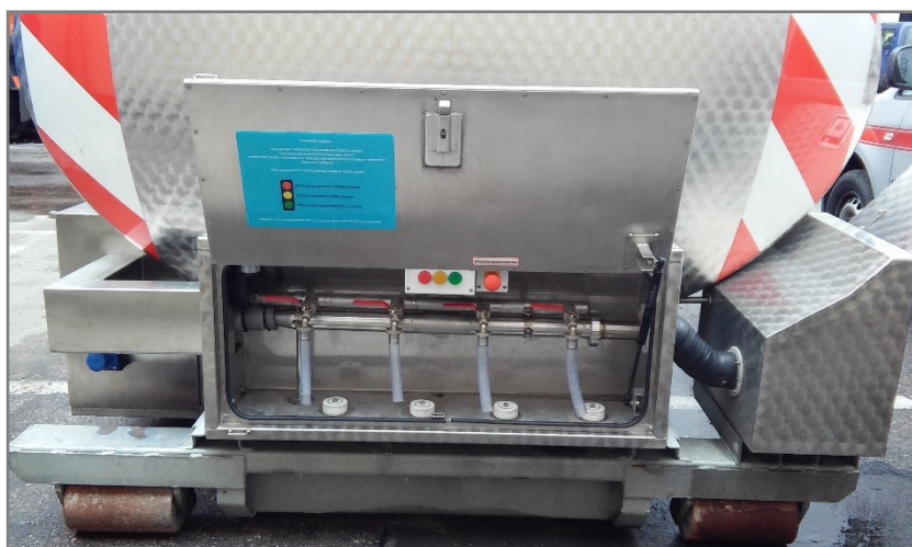
Kurki probiercze z układem lampek sygnalizacyjnych informujących o statusie urządzenia.
