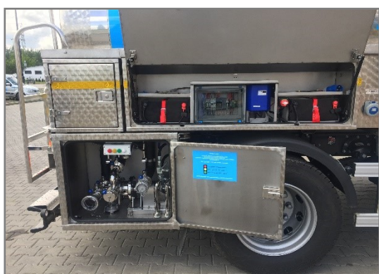
Moduł Aquasave zabudowany na istniejącym pojeździe ciężarowym.
