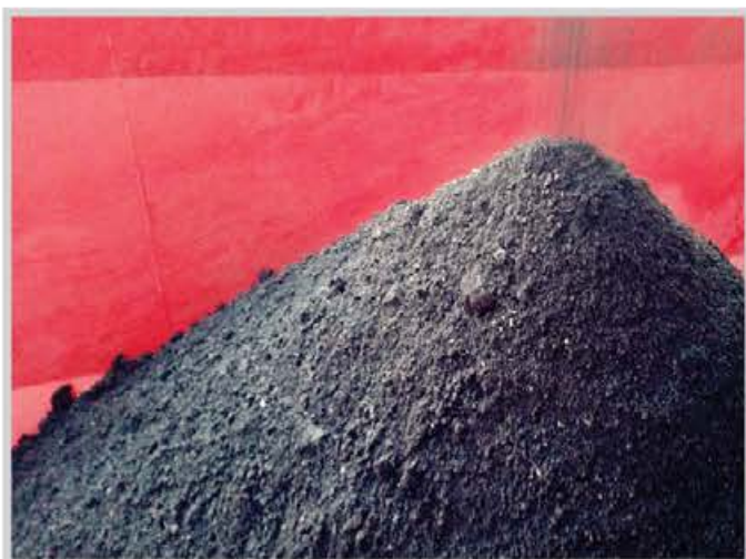
Oczyszczalnia Ścieków w Puławach – osad odwodniony na prasie tłokowej Bucher – 28% s.m.
