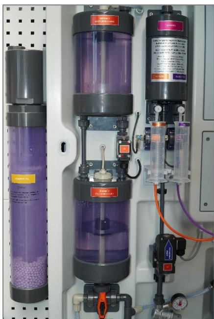
Zbiorniki połączone szeregowo, wykonane z przezroczystego materiału (możliwa bezpośrednia kontrola poziomu cieczy)
