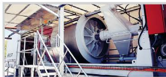
Pełnowymiarowa – mobilna stacja odwadniania osadów oparta na prasie HPS 3007
